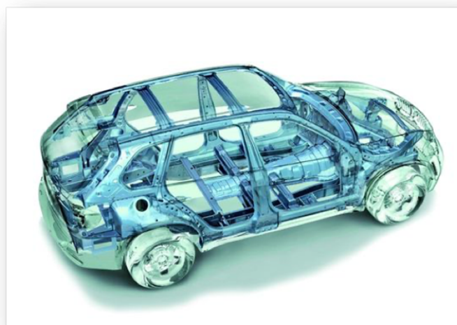
Abbildung 2.6: Einsatz hochfester Stähle im Automobilbau zur weiteren Gewichtsreduzierung.
