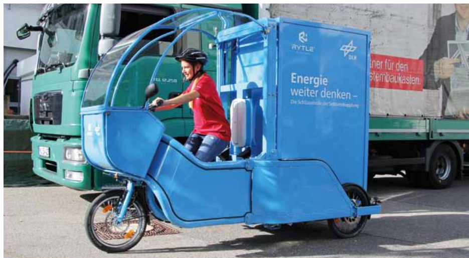
Lang unterwegs Die durchschnittliche Reichweite des Cargo-Bikes mit Brennstoffzelle liegt bei bis zu 200 Kilometern. Bild: DLR Fotomedien
