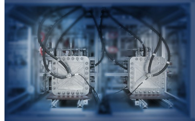
Polymerelektrolytmembran-basierte Stack-Kombination bei der Charakterisierung im Elektrolysesteststand (FZJ)
